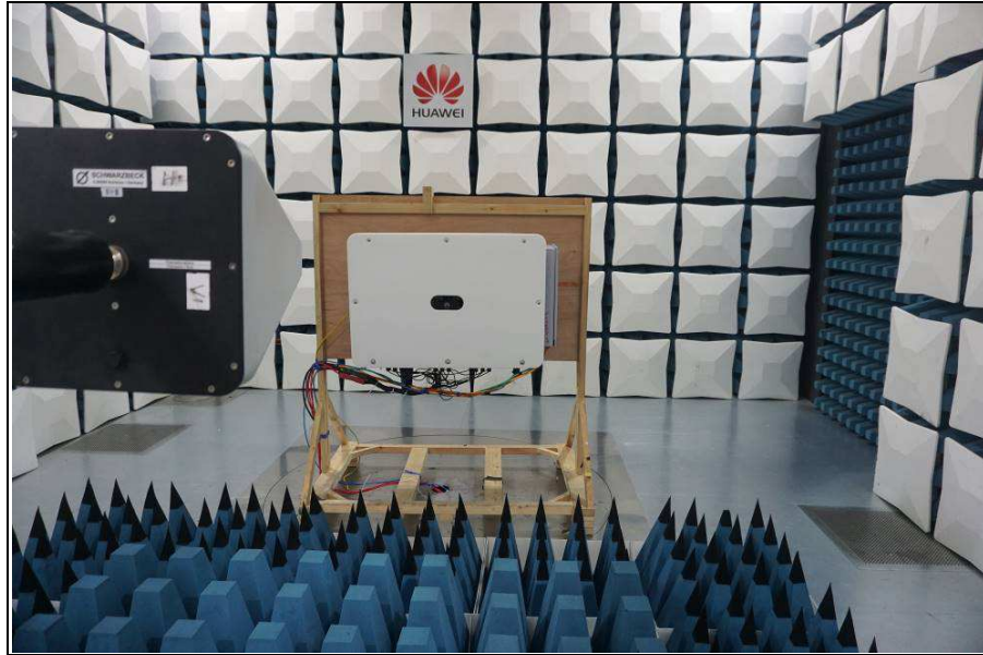
EFT TEST (AC Power Port)
