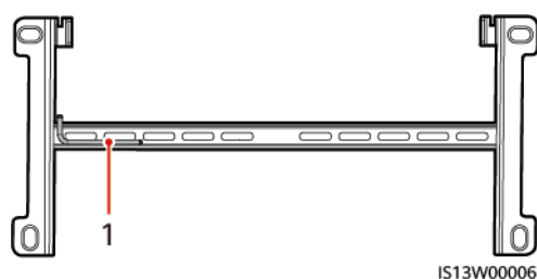
Figur 4-8 Position för bindning av säkerhetstorxnyckeln
